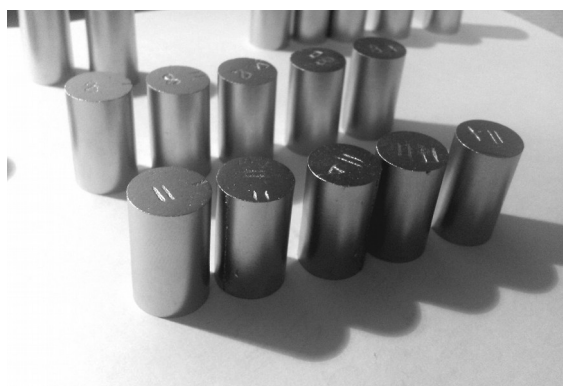
Рисунок 11 – Фотография изготовленных образцов сплава Fe-Cr-Co
